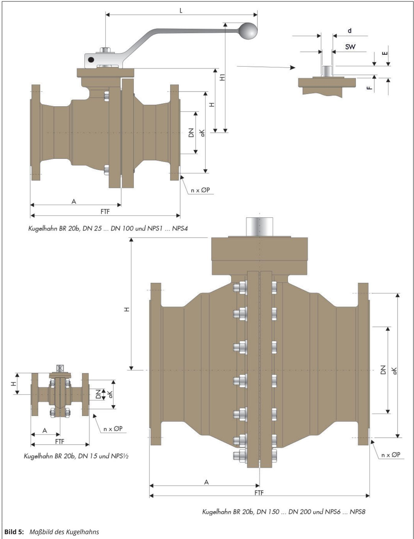
**Bild 5:** Maßbild des Kugelhahns
