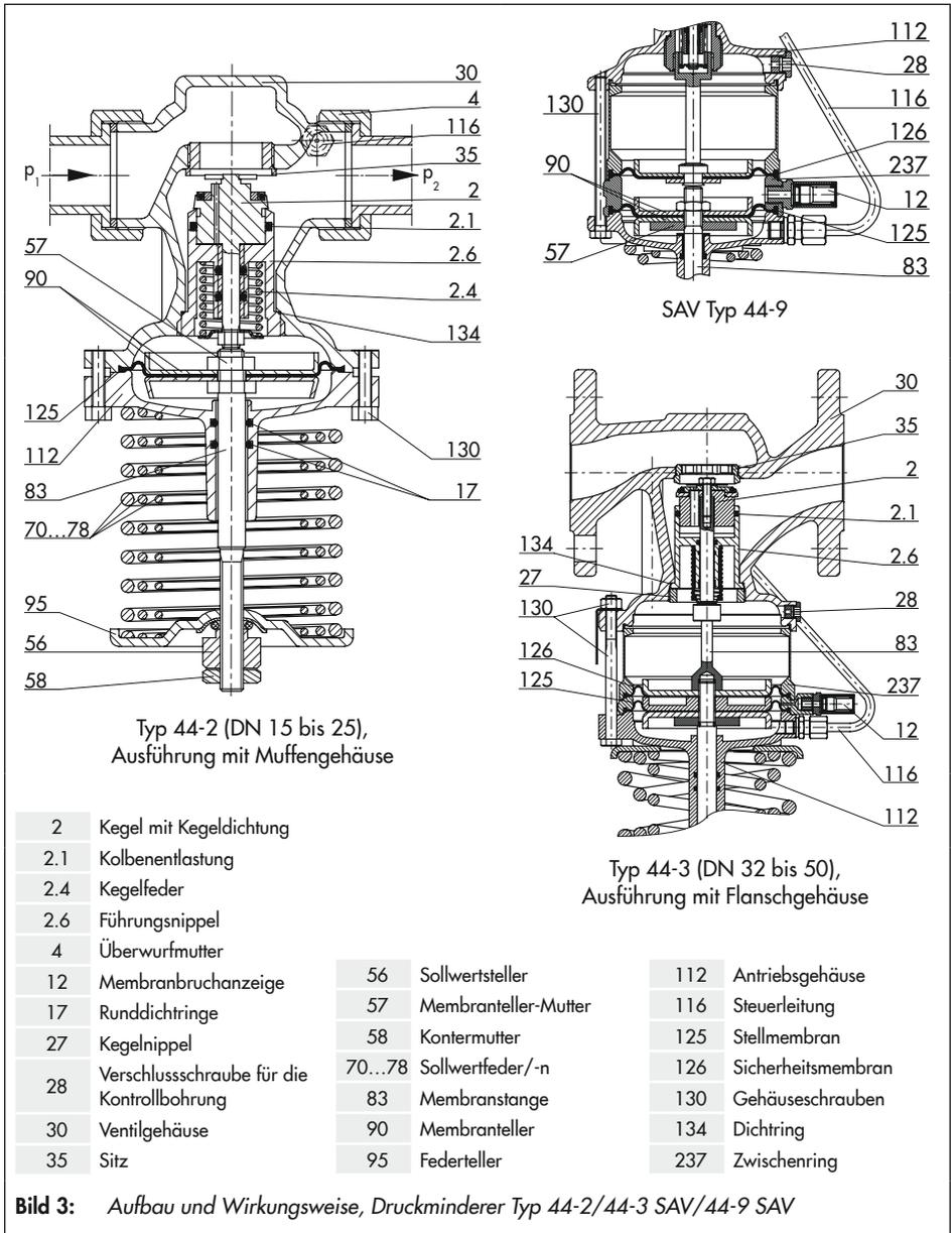
**Bild 3:** Aufbau und Wirkungsweise, Druckminderer Typ 44-2/44-3 SAV/44-9 SAV
