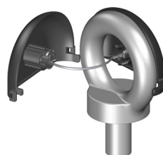
图4-4: 已打开的吊环螺栓护盖 (带绑带)
