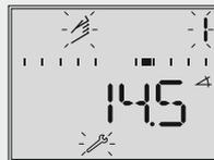
Handsollwert (angezeigt wird der aktuelle Drehwinkel)
