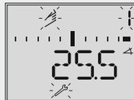
Handsollwert  $w$  (angezeigt wird der aktuelle Drehwinkel)
