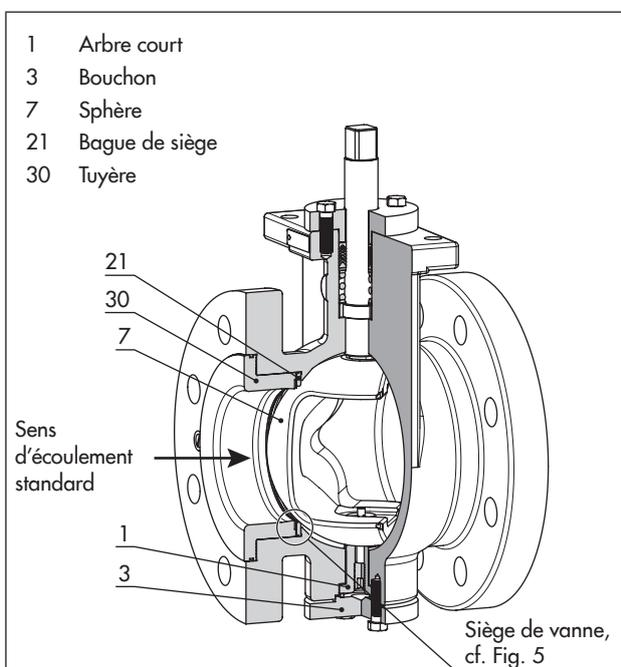
Fig. 3 : Vanne à segment sphérique type 3310
